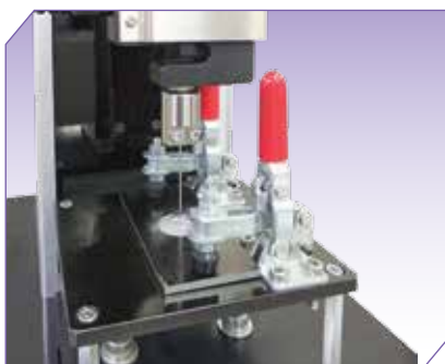
Измерение силы нажатия шприца
