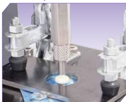
Испытание металлических пластин на изгиб
