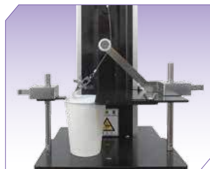
Испытание таблеток на прочность
