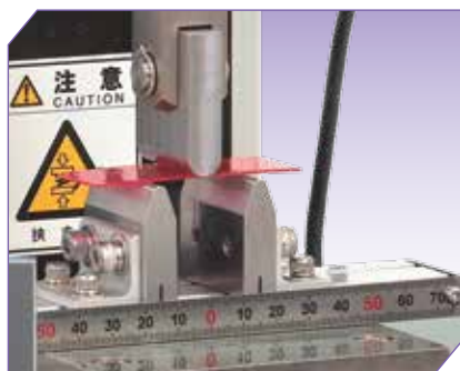
Испытание металлических пластин на изгиб
