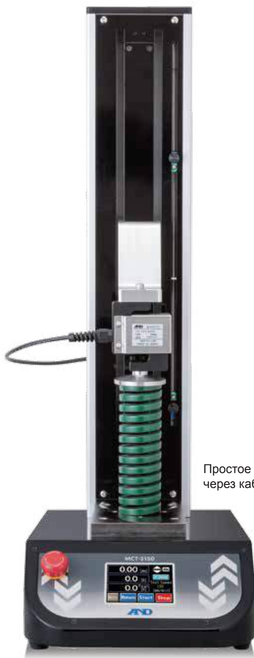
На рисунке изображено испытание пружины
