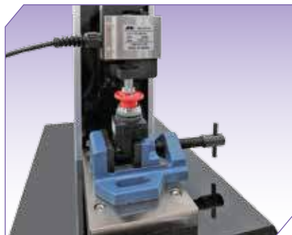
Испытания упаковочной тары на сопротивление сжатию
