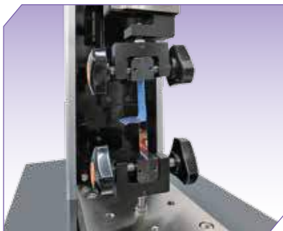
Испытание пластиковой тары на сопротивление сжатию
