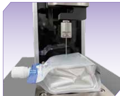
Испытание упаковочной тары на отслаивание
