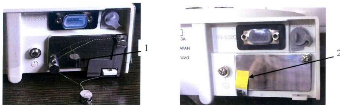
Рисунок 2 – Схема пломбировки от несанкционированного доступа, обозначение места нанесения знака поверки (1 – свинцовая или пластиковая пломба; 2 – пломба в виде разрушаемой наклейки)
